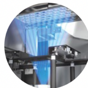
Skanowanie kodów 2D umożliwia śledzenie próbek.
