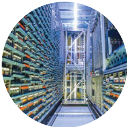
Robot przemieszczający tacę i przenoszący próbki do odpowiednich lokalizacji i chwytaka wewnątrz Verso.
